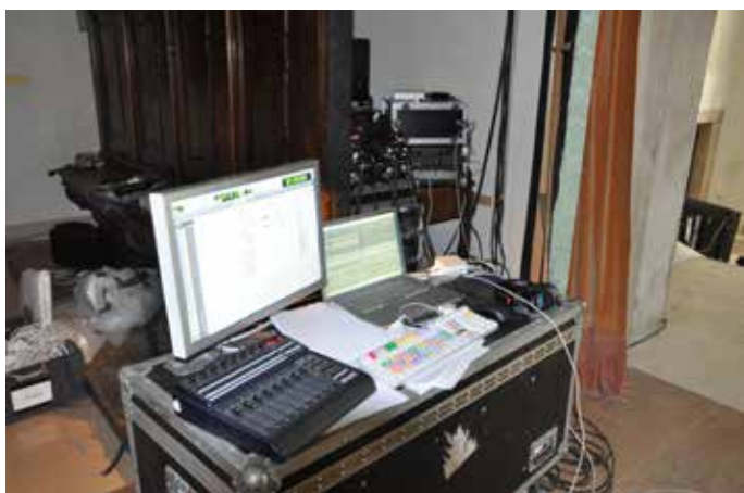
Postazioni di lavoro sul luogo: postazione di mastering connessa alla regia e al sistema di diffusine (sx) e postazione di editing, basate su Avid Pro Tools.
