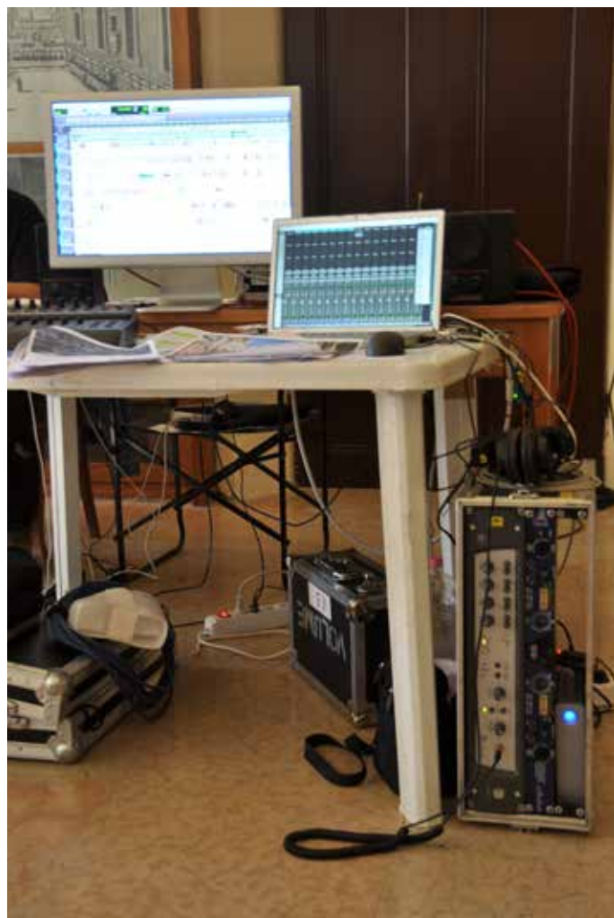
Postazioni di lavoro sul luogo: postazione di mastering connessa alla regia e al sistema di diffusine (sx) e postazione di editing, basate su Avid Pro Tools.
